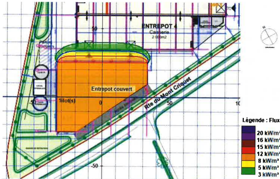
Figure 33 : PhD5 : effets thermiques générés par l'incendie généralisé de l'entrepôt couvert - Hcible = 1,8 m
